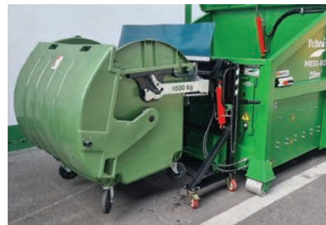
Mobilni podizač za kante i kontejnere - brza hidraulička spojka
