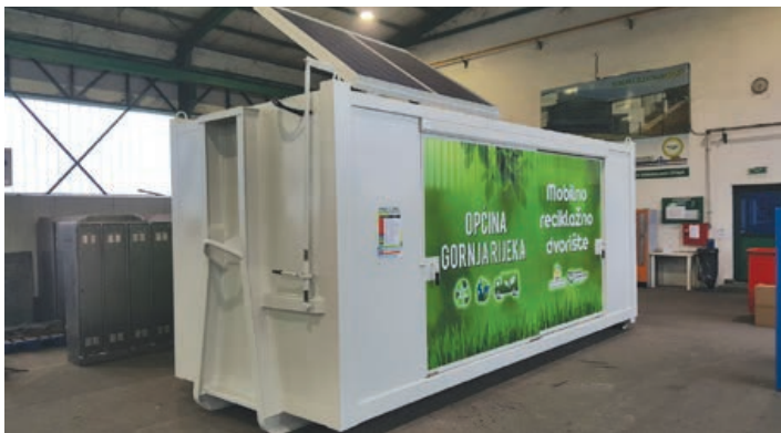
Energetski neovisno mobilno reciklažno dvorište
