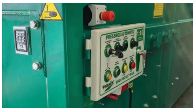
Technix preskontejner upravljani s elektronskom ID karticom, otiskom prsta i šifrom
