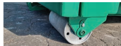
Čelični kotači s podmazivanjem
