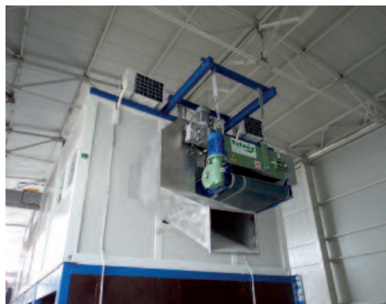
Automatsko odvajanje metala iz otpada
