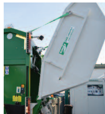
Automatsko pražnjenje prihvatne komore unutar i izvan kabine
