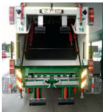
Tehnix podizač kanti i kontejnera od 80 do 1100 litara
