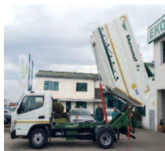
Pretovar prikupljenog komunalnog otpada iz manjeg u veće vozilo
