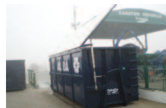
Rolokontejner s okretnim poklopcem
