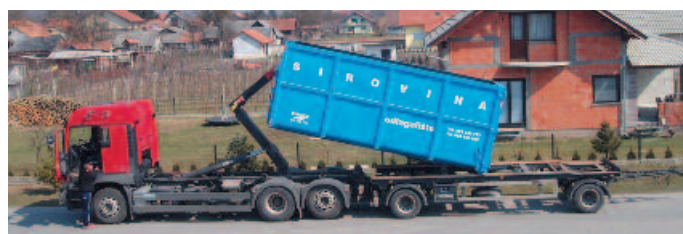
Brzi istovar i uтовar tereta, praktična zamjena - puno za prazno
