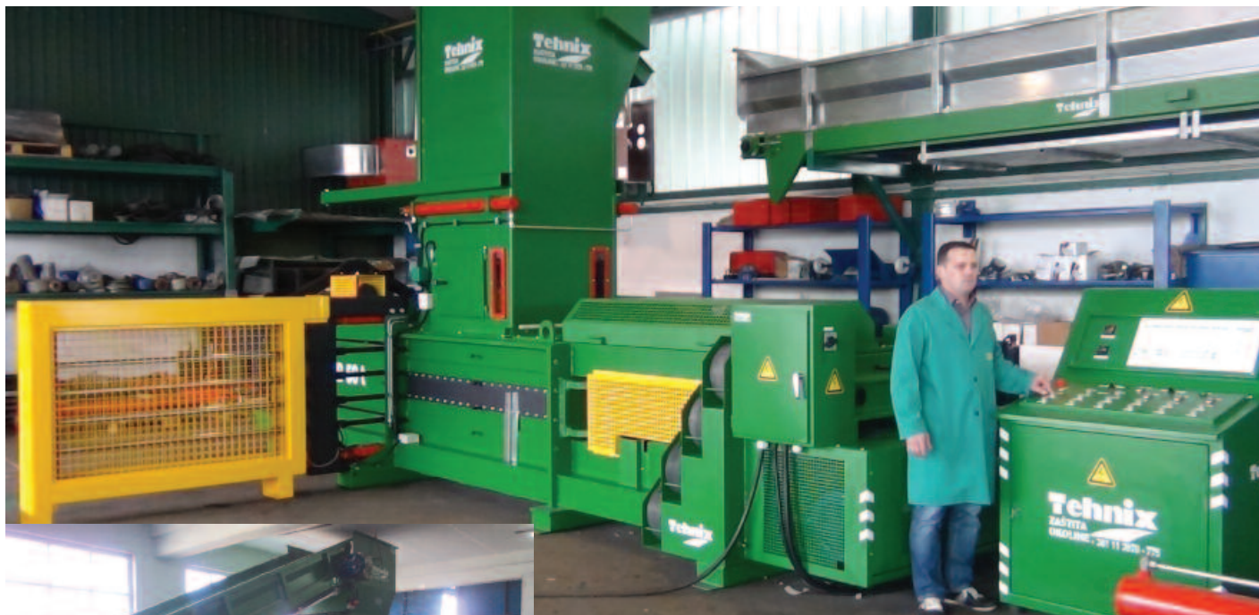
Automatska preša balirka s dodatnom opremom za baliranje materijala i upravljačkim ormarom
