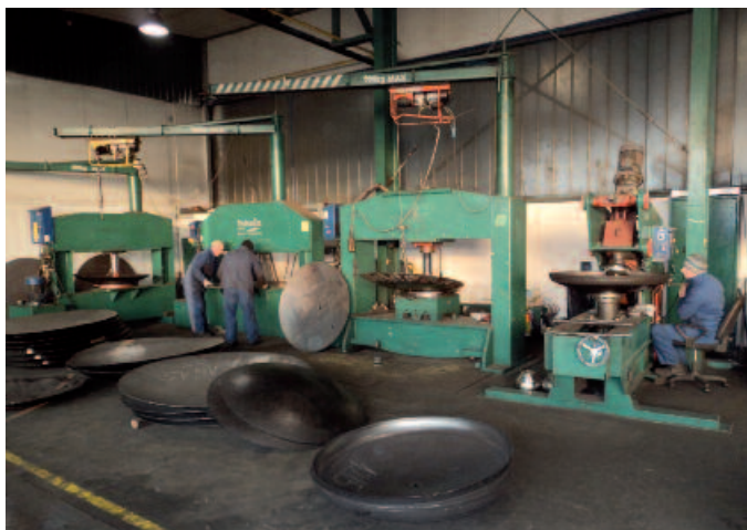
Proizvodnja podnica debljine lima od 15 mm i promjera od 500 do 3000 mm prema normi DIN 28011 (plitke) i DIN 28013 (duboke)
