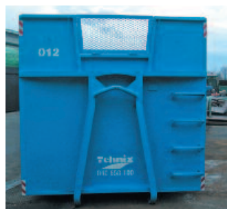
Rolokontejner s otvorom za kran
