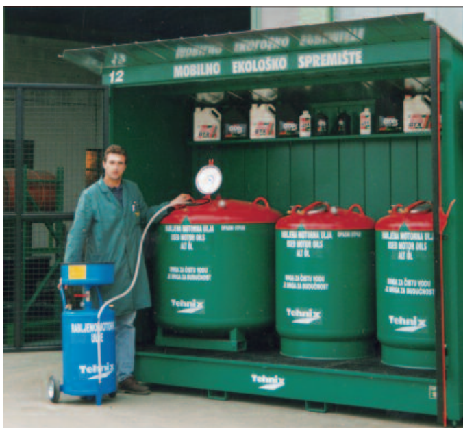
Prihvatanje rabljenog motornog ulja u eko-kontejner
