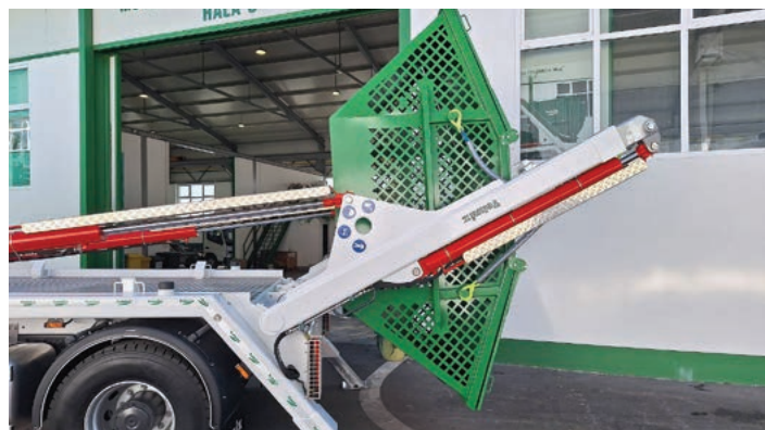
Standardni istovar preko zahvatne kuke
