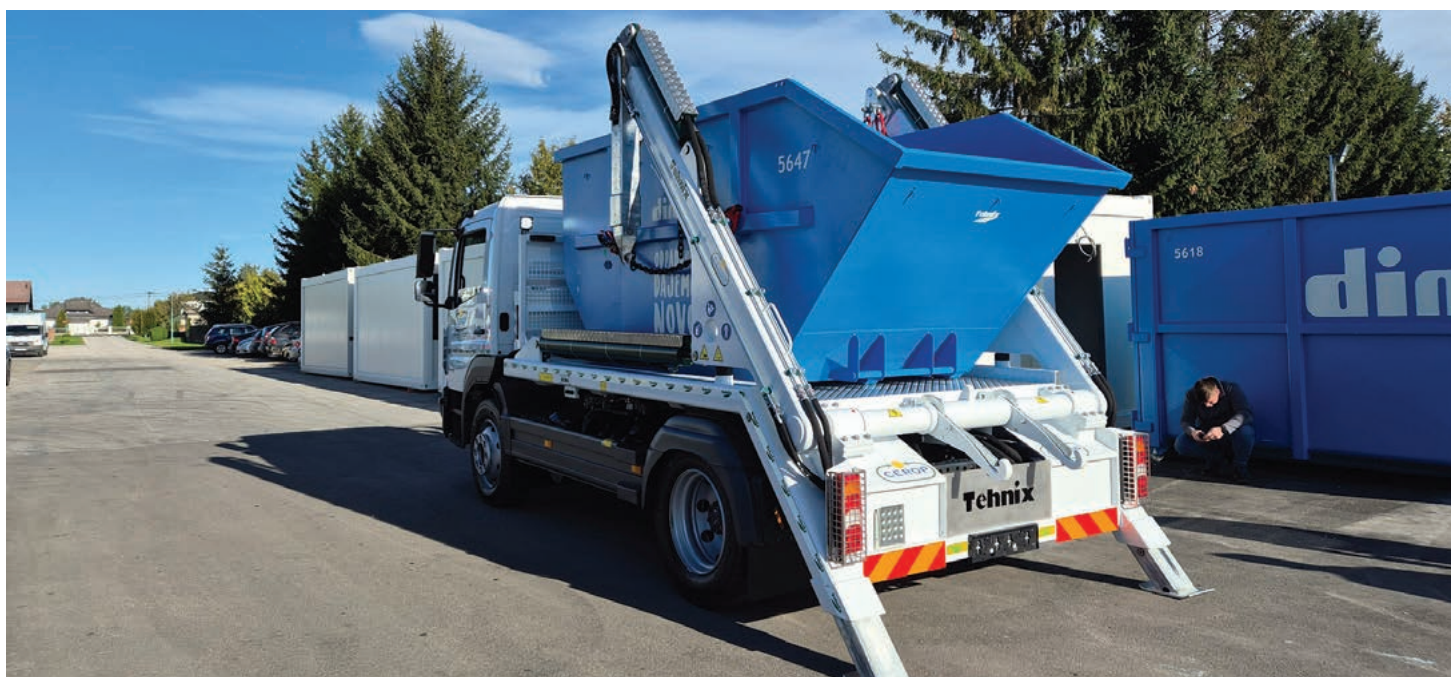
Stabilizatori i ruke pojedinačno upravljivi za lakšu manipulaciju
