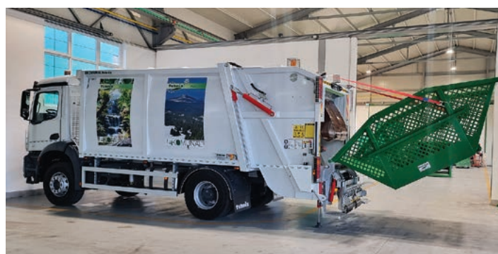
Pražnjenje 5 i 7 m 3 komunalnih kontejnera
