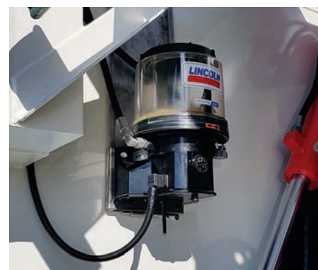
Automatsko podmazivanje kliznih površina u 14 točaka
