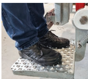
Ergonomski oblikovano stajno mjesto prema ISO 2631
