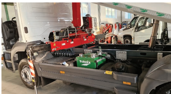
Dvostruko upravljanje kranom - fiksno i radijsko
