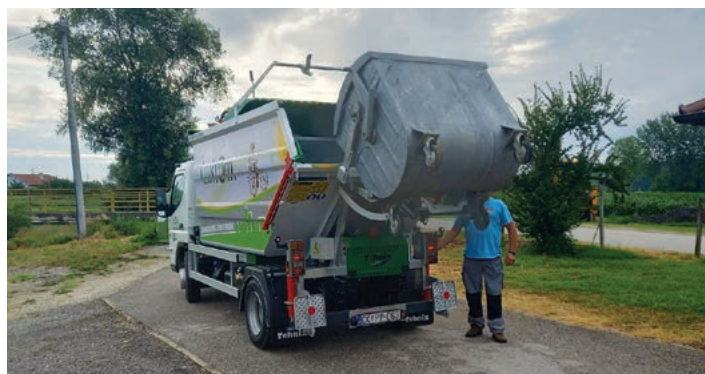
Pražnjenje pocinčanih 1100 l komunalnih kontejnera
