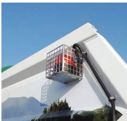
Zaštitni kavez rotacijskih svjetala
