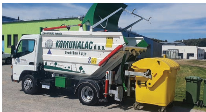
Podizanje PVC kanti i kontejnera
