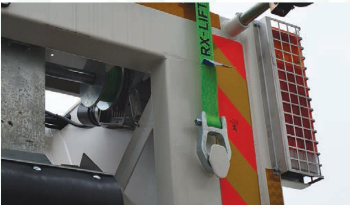
Sustav za podizanje 5-7 m 3 kontejnera
