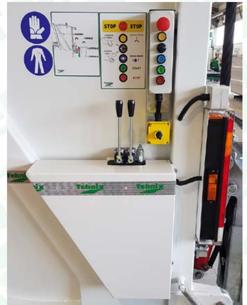
Identifikacijski sustav - RFID i upravljački mehanizam EKOMUNAL nadogradnje
