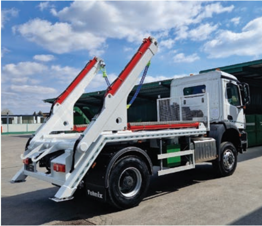
TEHNIX samopodizač sa zimskom službom
