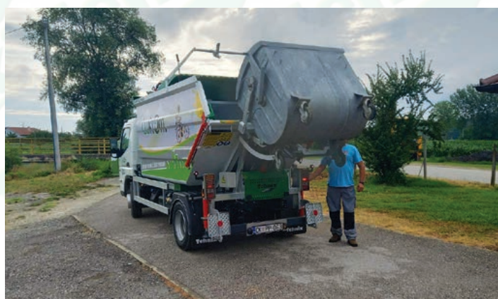
Pražnjenje pocinčanih 1100 l komunalnih kontejnera
