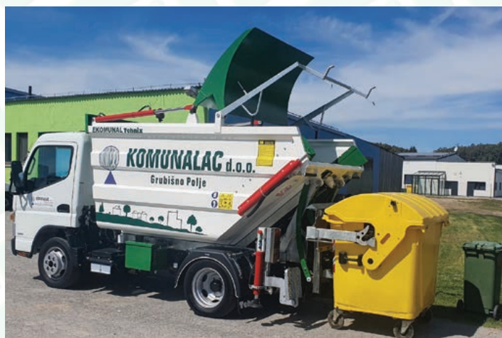
Podizanje PVC kanti i kontejnera
