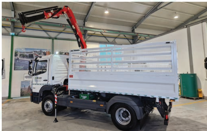
Posebni TEHNIX nastavci - montažno-demontažne stranice
