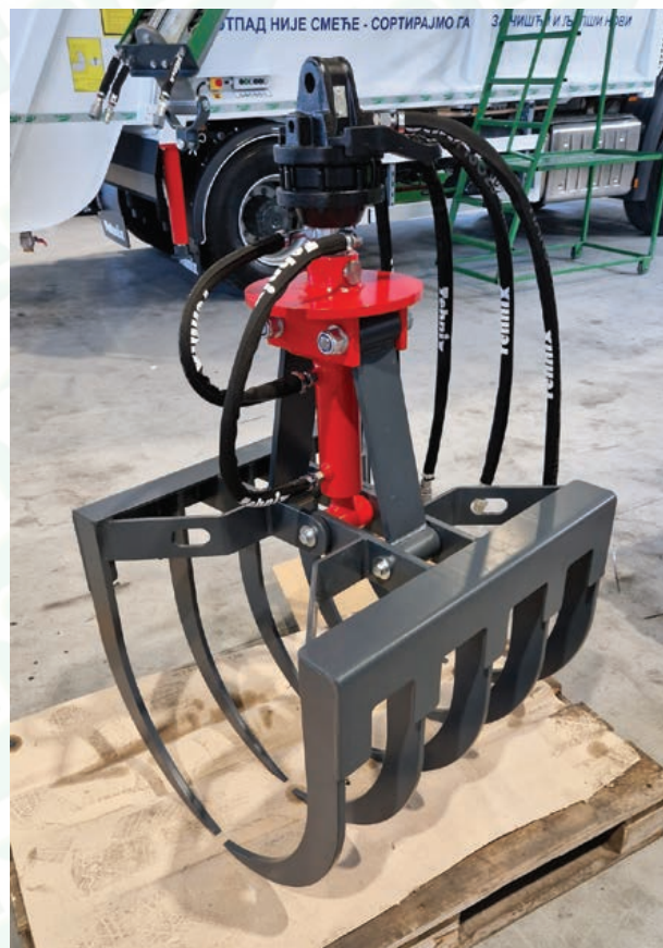
TEHNIX grabilica kapaciteta 0,4 i 0,8 m 3
