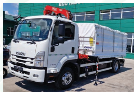
Trostrani kiper s alumijskom pocinčanom nadogradnjom, kranom i ceradom
