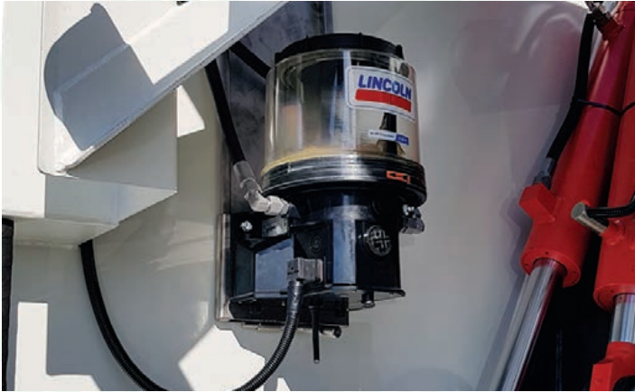
Automatsko podmazivanje kliznih površina
