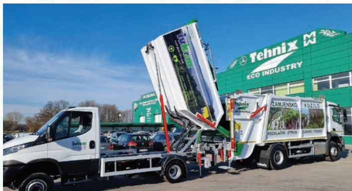
Mogućnost pretovara malih u velika vozila pomoću hidrauličnih produžetaka za potpunu preciznost i dodatnu čistoću
