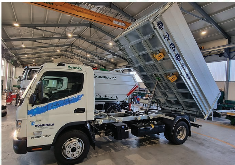
Trostrani kiper s alumijskom pocinčanom nadogradnjom, kranom i ceradom
