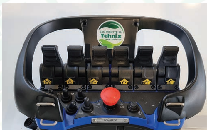
Manevriranje kranom s radijskim upravljanjem
