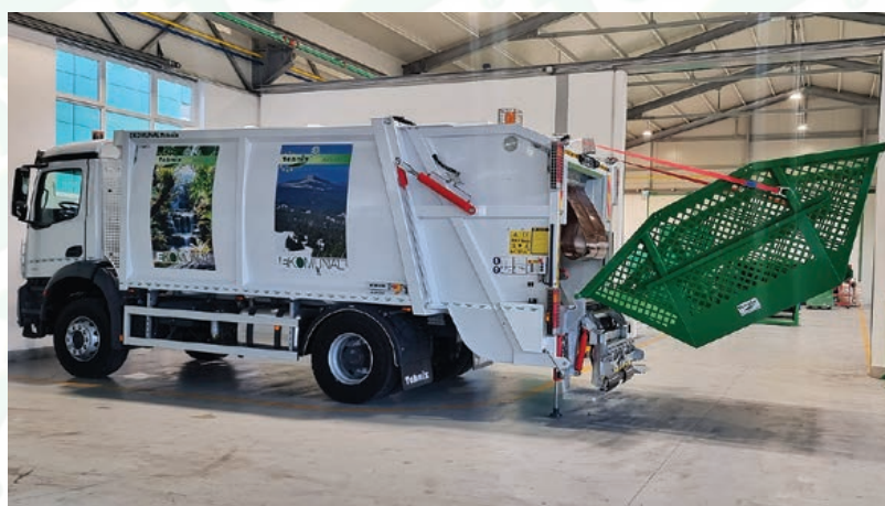
Pražnjenje 5 i 7 m 3 komunalnih kontejnera
