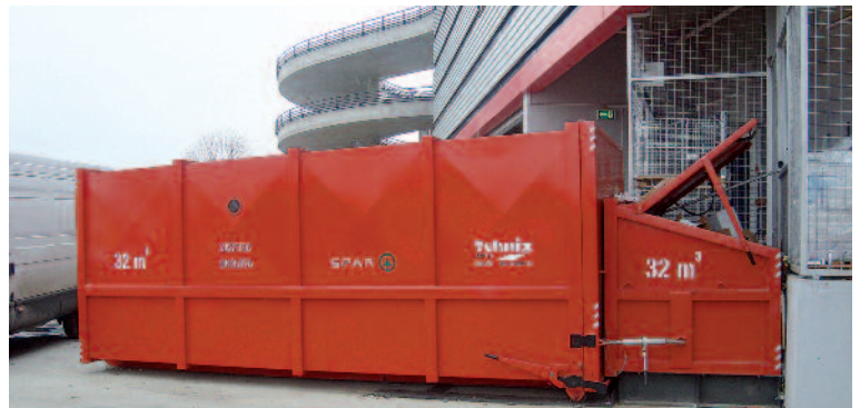
Preskontejneri dvodjelni rolo 32 m 3 , do 10 tona
