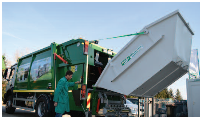
Tehnix podizač kontejnera od 5 i 7 m 3
