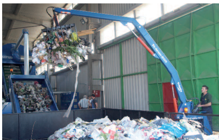
TEKRAN TEHNIX - za doziranje mješanog komunalnog otpada
