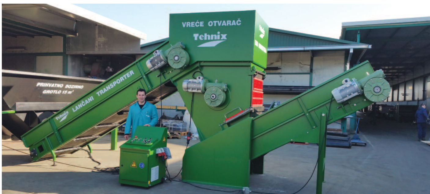
Otvarač vreća tip TEHNIX - kapaciteta od 5 do 20 t/h, mogućnost otvaranja vreća od 5 do 50 kg
