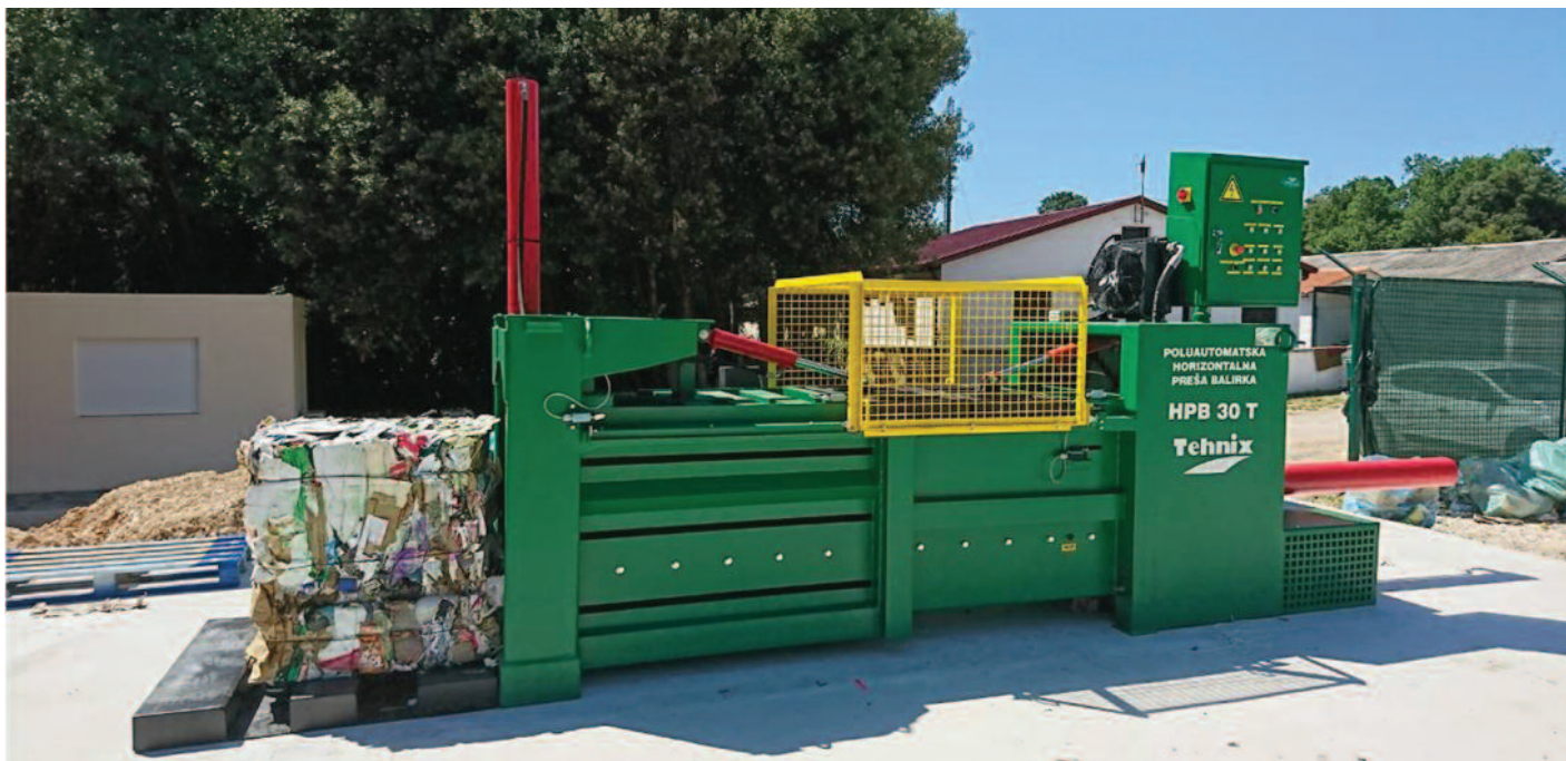
Horizontalne preše balirke HPB-25 i HPB-35 tip Tehnix
