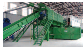
POSTROJENJA ZA GOSPODARENJE KOMUNALNIM OTPADOM TIP TEHNIX KAPACITETA OD 15 DO 20 t/h
