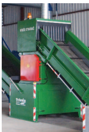
Otvarač vreća tip TEHNIX - kapaciteta od 5 do 20 t/h, mogućnost otvaranja vreća od 5 do 50 kg
