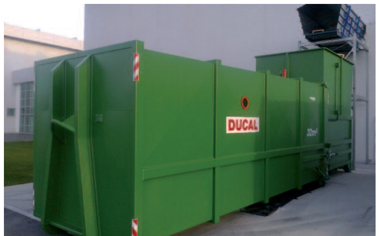
Specijalna izvedba dvodjelnog preskontejnera s podizačem
